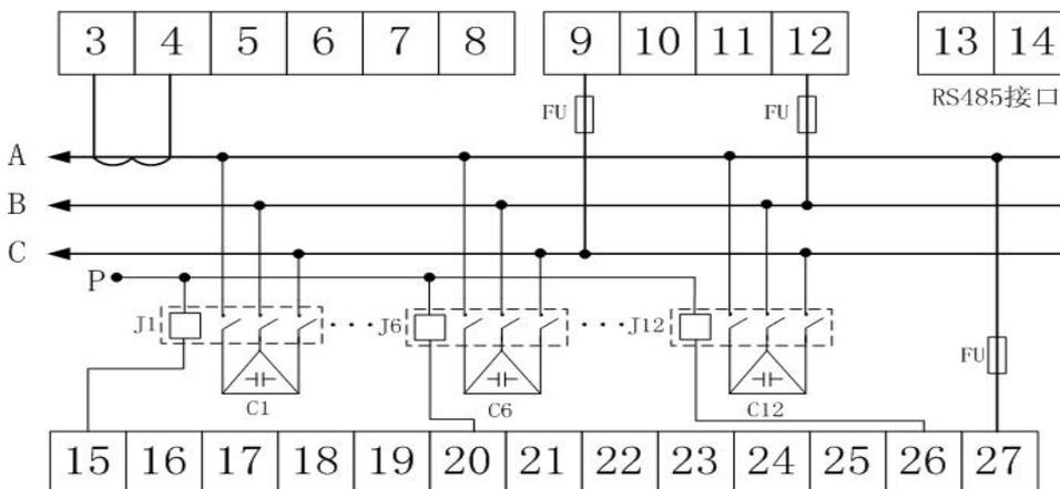
接触器额定工作电压是220V时，P接电网零线，接触器额定工作电压是380V时，P接电网B相或者C相
