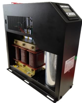
EICX系列抗谐波型智能电容器是0.4KV、50Hz 低压配电高效节能、降低线损、提高功率因数和电能质量的新一代抗谐波无功补偿设备。它由智能测控单元，晶闸管或复合开关电路，线路保护单元，电抗器电力电容器构成。替代常规由熔丝、复合开关或机械式接触器、热继电器、低压电力电容器、指示灯等散件在柜内和柜面由导线连接而组成的自动无功补偿设备。它改变了传统无功补偿装置体积庞大和笨重的结构模式，从而使新一代低压无功补偿设备具有补偿效果更好，体积更小，功耗更低，价格更廉，节约成本更多，使用更加灵活，维护更方便，使用寿命更长，可靠性更高的优点，适应了现代电网对无功补偿的更高要求。
