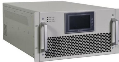
JX-APF有源电力滤波器是利用现代电力电子技术和基于高速DSP器件的数字信号处理技术制成的新型电力谐波治理专用设备。它使用最先进的数字信号处理器作为控制器，采用IGBT半导体作为开关器件，并采用业内先进的三电平拓扑，以获得最好的补偿效果。
