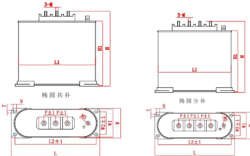
注：共补电容器上接线端子依次是 A、B、C、接地端，分补电容器上接线端子依次是A、B、C、N、接地端。
